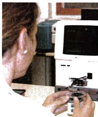
Una delle prove di laboratorio: la verifica del potere ottico delle lenti
