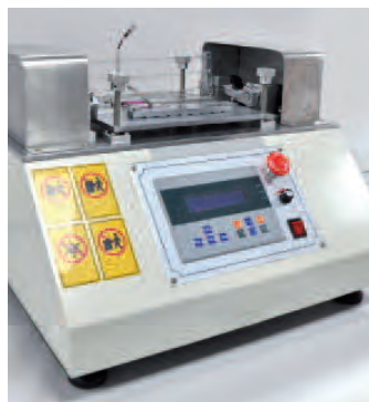
Strumento che testa la stabilità delle cerniere flex con 2.000 aperture e chiusure dell'asta.
