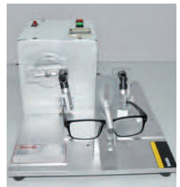
Strumento che testa la stabilità meccanica della montatura, delle aste e delle cerniere flex con 500 rotazioni delle aste.
