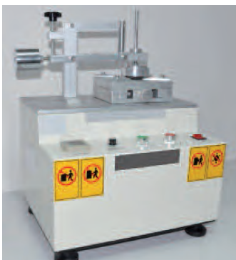
Strumento che testa la resistenza ai graffi.
